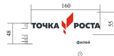
Размеры декоративных элементов (1:10) Толщина 0,6 см
